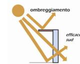
**SCHERMATURA SOLARE DELLE FINESTRE**
